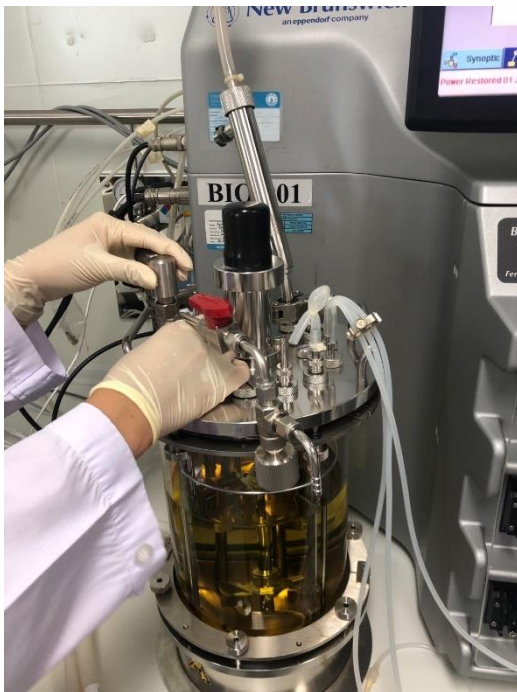
การขยายกำลังการผลิตเปปไทด์ (up-scaling) ในถังหมัก (bioreactor)
